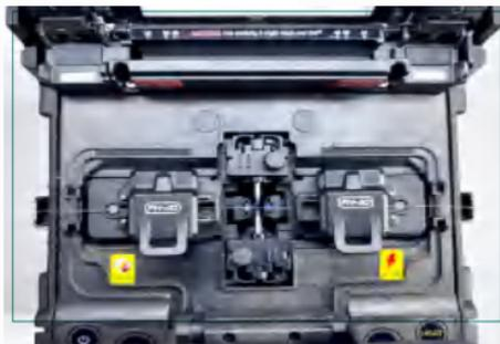
注意：请勿沿着 V 型槽滑动光纤。光纤切面应超出 V 槽位置，但不应超过电极棒尖端位置。（如图）
