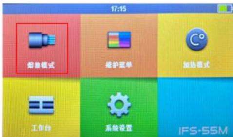
**注意：**熔接机出厂时设置为“自动熔接”，当关闭防风盖时便开始熔接。
